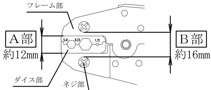
**B部** 圧着部付近が16mmを超えるコネクタは圧着工具のネジ部が当たらないように、向きを変えて作業してください。
