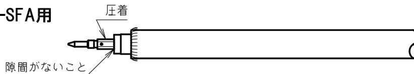
中心コンタクトを内部導体に装着し圧着工具Aの部分で圧着する。
