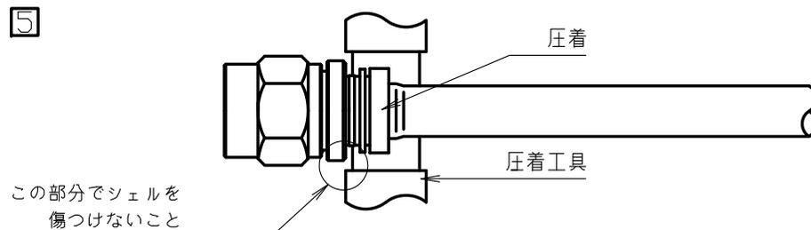
スリーブ部を圧着工具のBの部分で圧着させ作業を完了する。
