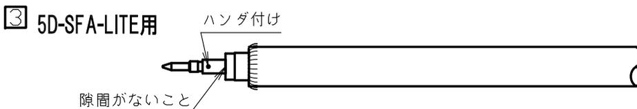
中心コンタクトを内部導体に装着し、ハンダ付けする。
