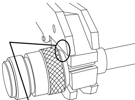
**A部** ダイス幅よりもフレーム部の幅が大きく、コネクタの圧着部付近が下記寸法よりも大きいコネクタは接触しないよう注意が必要です。
