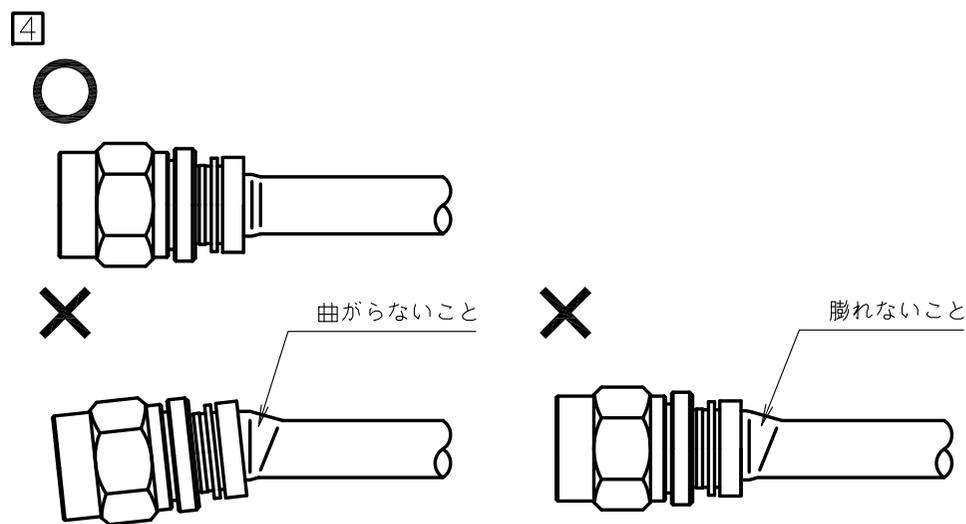
シェルを同軸ケーブルの外部導体とアルミ箔の間に真っ直ぐ入るように装着し中心コンタクトが定位置に入ったことを確認する。
